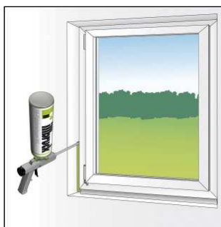
Prozorna fuga ispuniti sa pijenom
